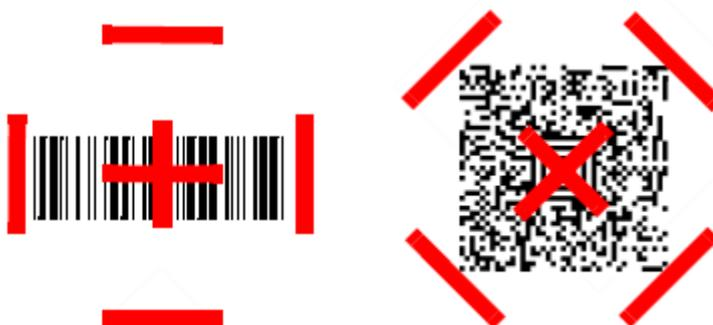
Richten Sie den Scanner mit Hilfe der über den Sucher ausgegebene Ziellinien bzw. des Zielmusters mittig über dem Barcode aus, so dass alle Bestandteile dessen gelesen werden können. Positionieren Sie den Zielstrahl mittig auf dem Barcode. Durch Änderung des Abstands zwischen Scanner und Bar-
